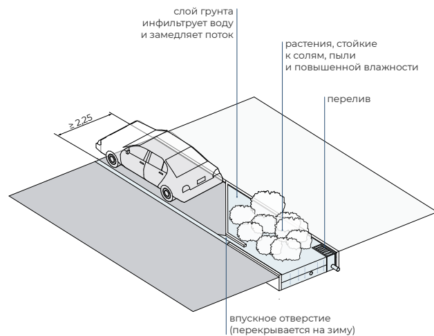
БИОДРЕНАЖНАЯ КАНАВА НА ИСКУССТВЕННЫХ СУЖЕНИЯХ ПРОЕЗЖЕЙ ЧАСТИ
