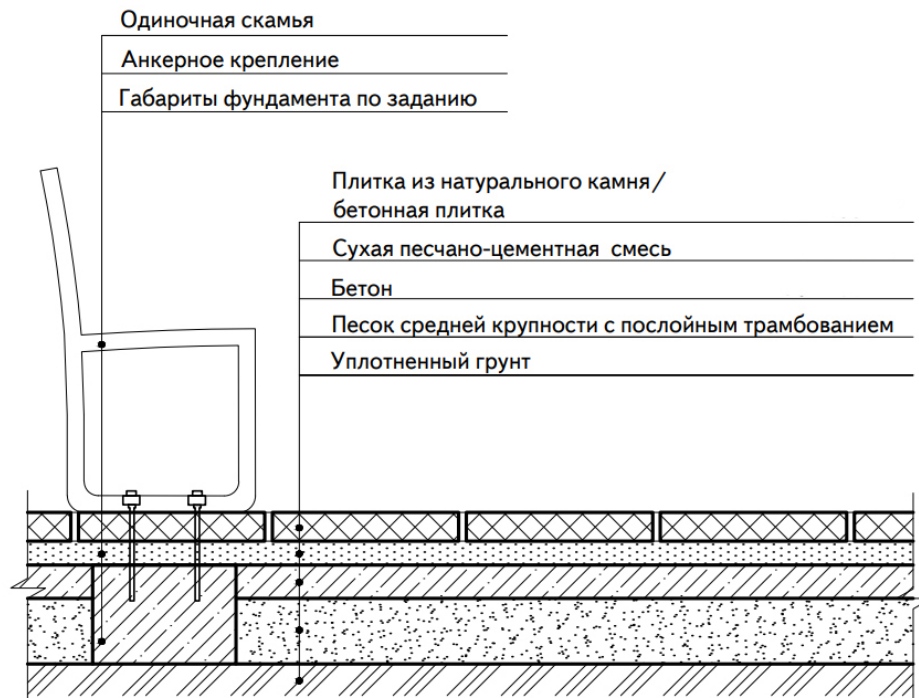
Илл. 5.1.1. ПРИНЦИПИАЛЬНАЯ СХЕМА МОНТАЖА СКАМЬИ В МОЩЕНИЕ
