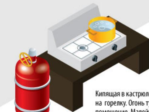
Кипящая в кастрюле вода попадает на горелку. Огонь тухнет. Газ заполняет помещение. Малейшая искра (зажженная спичка, нажатие клавишей выключателей и т.д.) приводит к взрыву
